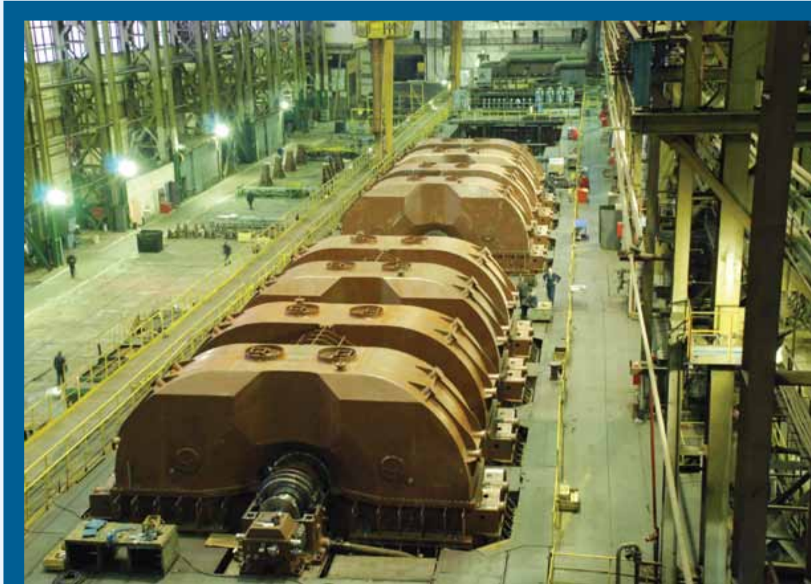
Головной образец новой быстроходной турбины мощностью 1200 МВт, спроектированной и изготовленной «Силовыми машинами», на заводском сборочно-испытательном стенде. Он предназначен для Нововоронежской АЭС-2.
